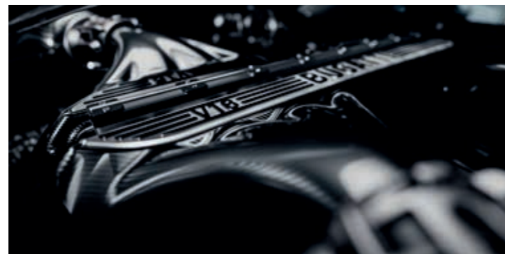
Bugatti Tourbillon : V16 Cosworth 8,3l - 1,775bhp at 9,000 rpm / 1 775ch à 9 000 tr/mn
