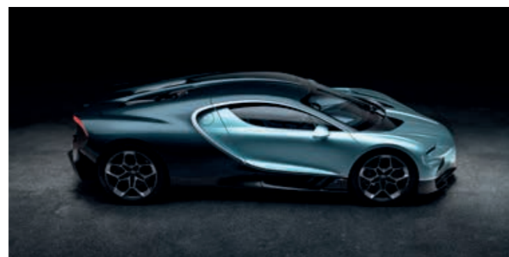
Bugatti Tourbillon : V16 Cosworth 8,3l - 1,775bhp at 9,000 rpm / 1 775ch à 9 000 tr/mn
